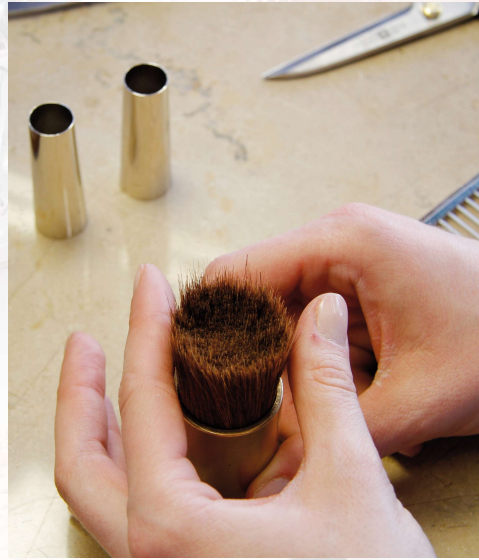
2. Stoßen des Haargutes in einer Messingbüchse
