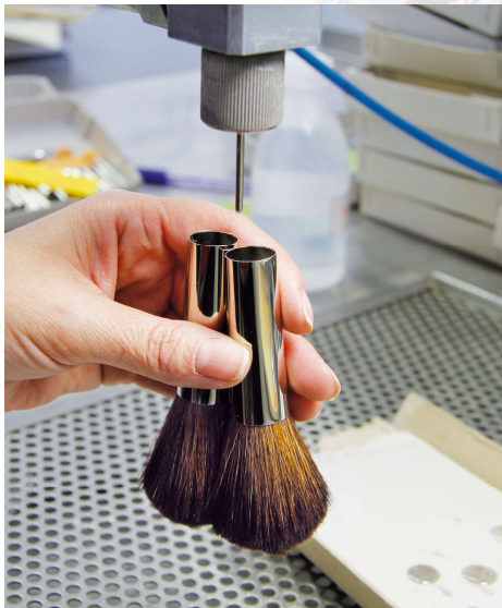
5. Verleimen der Haare in die Zwinge
